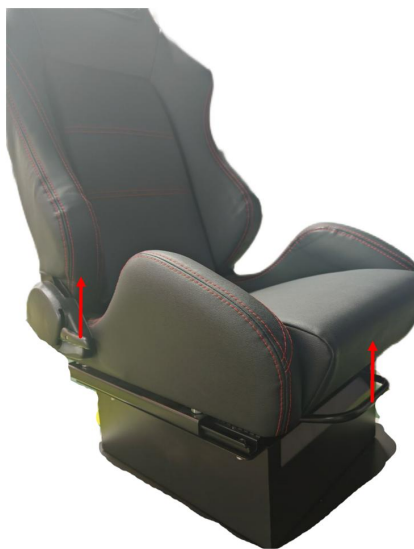
图 11 座椅调节手柄示意图
