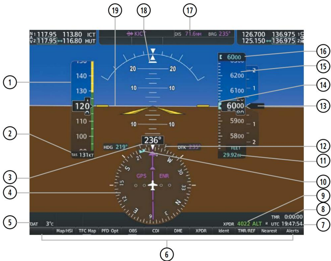
图 6 主飞行显示（PFD）画面介绍
